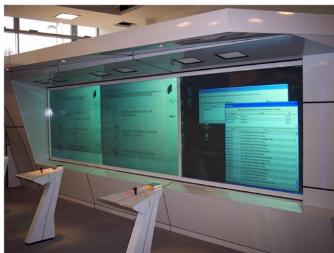
Smart Glass - tryb OFF + projekcja obrazu komputerowego
